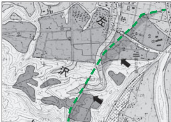
▲地図上の緑色の点線で表されているのが「左沢―根合田山断層」です。黒い線で囲まれているのは、海や河川によって形成された段丘面という地形であり、太い矢印は地殻変動による地形の傾きの方向を示しています。
