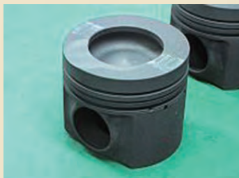
▲世界中で山形工場ではしか製造されない鋳鉄ピストン
